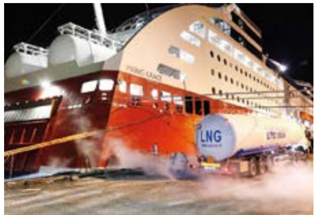
Image 18: MV Viking Grace – truck-to-ship LNG bunkering.
